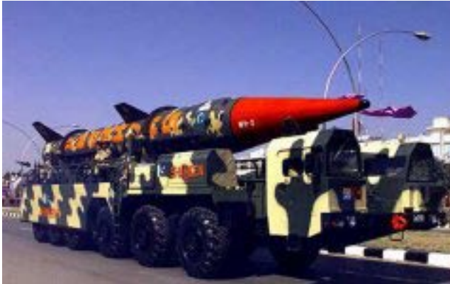
Figure 13 : Le Shaheen-II pakistanais serait un missile bi-étage à propergols composites d'une portée de 2 000 km
